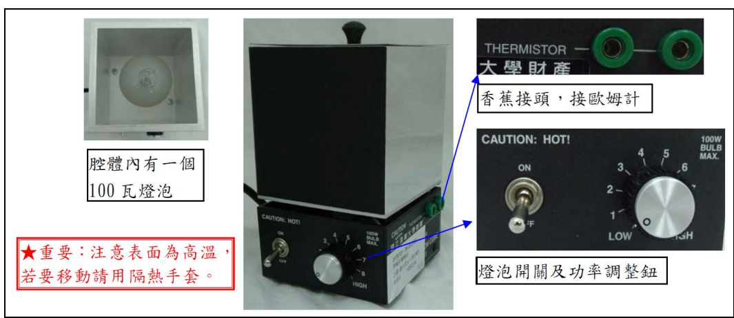
圖 3 熱輻射體之實體照片
