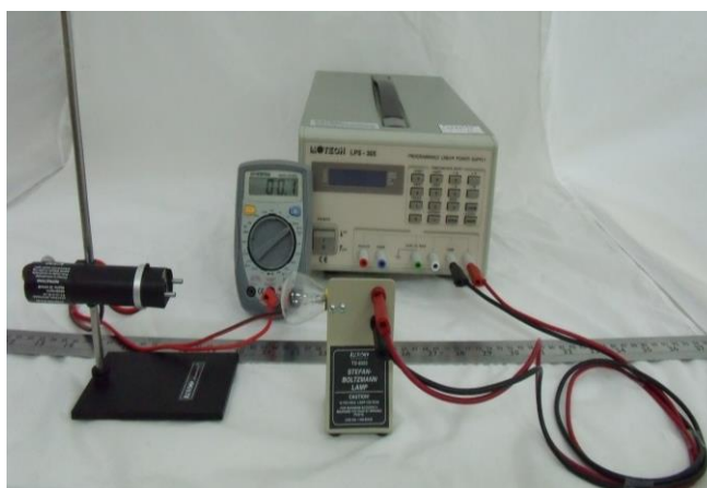
圖 7 點輻射之平方反比定律實驗儀器架構照片
