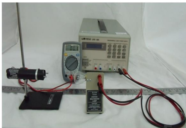
圖 8 高溫史蒂芬-波茲曼定律驗證實驗之儀器架設。
